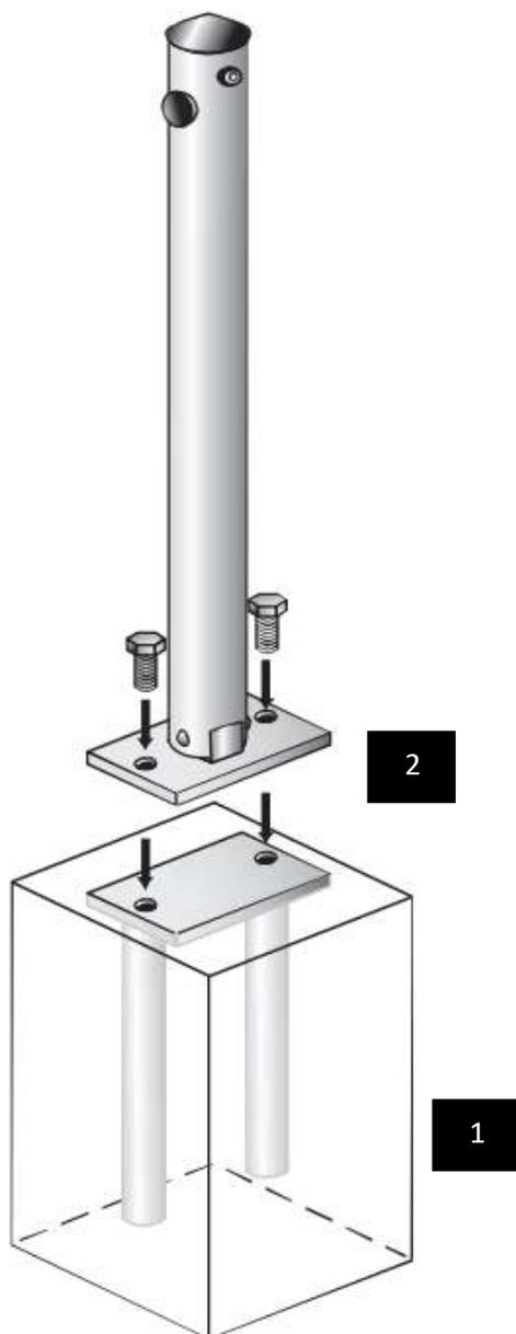
1. Der Bodenanker wird einbetoniert.
