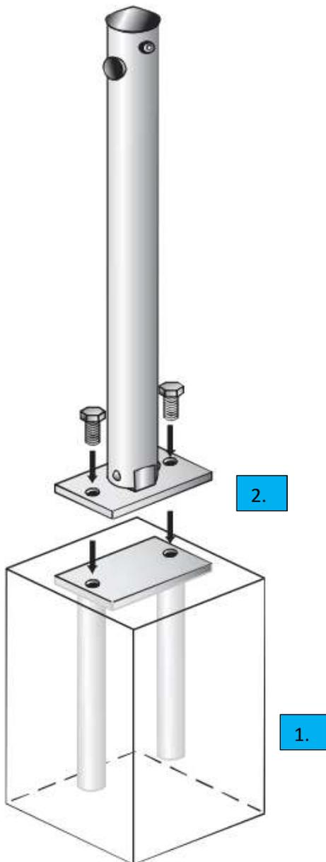
1. Der Bodenanker wird einbetoniert.
