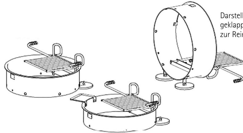
Darstellung in zurückgeklappter Position zur Reinigung
