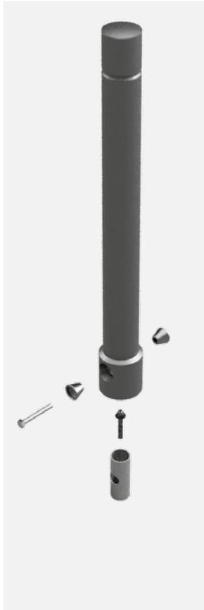
Das neue Multiflansch-Befestigungssystem bietet alle Vorteile der 3p-Technologie, kommt dabei aber ohne Bodenhülse aus. Stattdessen erfolgt die Montage mithilfe eines Verbindungsflanschs, der auf einem Punktfundament verschraubt wird.
