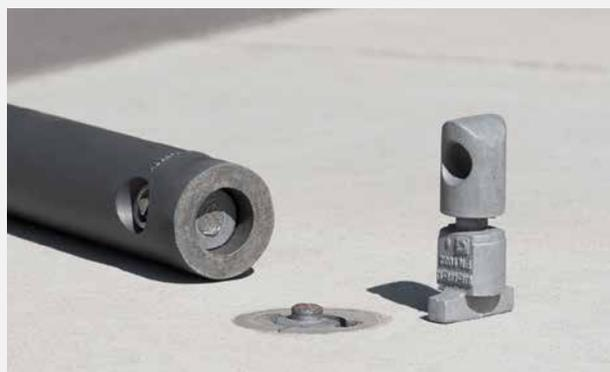
La pièce de jonction remplaçable se rompt à l'endroit prédéterminé à cet effet. Toutes les parties, y compris la borne, la fondation et le pavage, restent en bon état.
