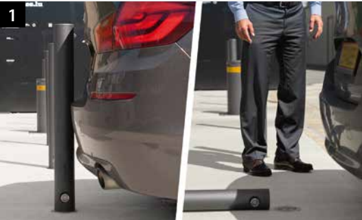
Der Poller wird durch ein Fahrzeug umgefahren. Das austauschbare Verbindungsstück bricht an der Sollbruchstelle. Poller und Fundament mit Bodenhülse bleiben in aller Regel unversehrt.
