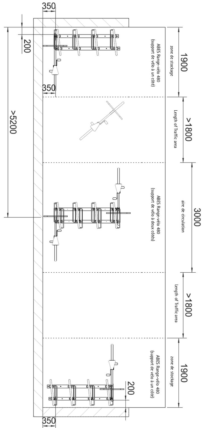
Espacement pour les range-vélos avec des positions de roues basses/haute : 500 mm
