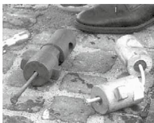
4 | Beschädigtes Verbindungsstück (rechts) und Ersatzteil (links)
