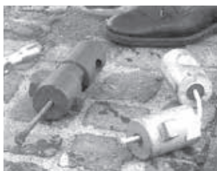
4 | Beschädigtes Verbindungsstück (rechts) und Ersatzteil (links)
