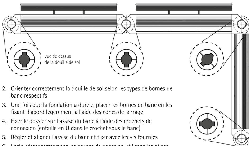
2. Orienter correctement la douille de sol selon les types de bornes de banc respectifs
